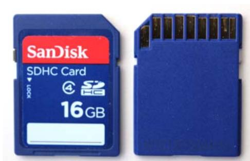
Abb. 1–3 Vorder- und Rückseite einer SD-Karte
